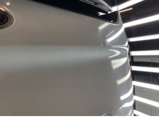
Bagaj kapağı/kapısı, Bagaj kapısı > Noktasal Ezik
