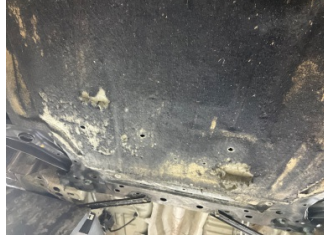
Motor, Alt muhafaza > Deforme Olmuş
