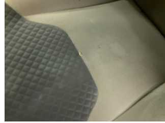
Döşemeler/Kapaklar, Döşemeler/Kapaklar > Yakıcı Madde ile Zarar Görmüş
