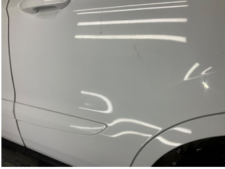
Kapı, sol arka, Kapı, sol arka > Çizik
