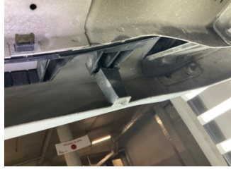
Tampon, arka, Bağlantı ayağı > Kırılmış
