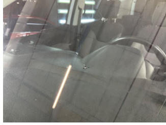
Camlar, Ön cam > Çatlak
