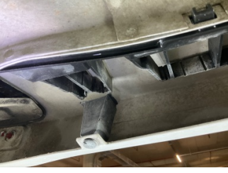
Tampon, arka, Bağlantı ayağı > Kırılmış
