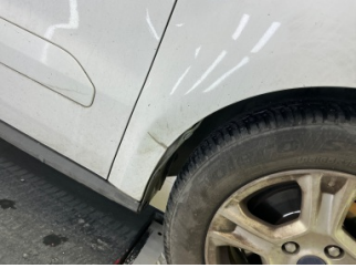
Çamurluk, sağ, Çamurluk, sağ > Hasarlı
