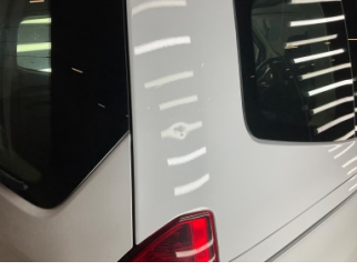
Çamurluk, sağ arka, Çamurluk, sağ arka > Ezik
