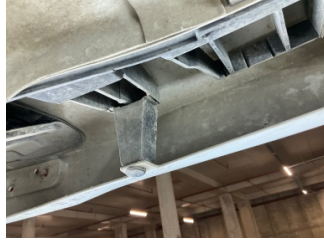
Tampon, arka, Bağlantı ayağı > Hasarlı
