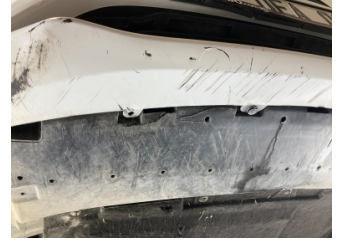
Tampon, ön, Tampon koruyucu orta > Hasarlı
