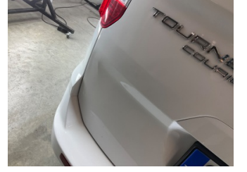
Bagaj kapağı/kapısı, Bagaj kapısı > Ezik
