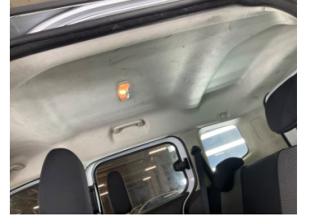
Döşemeler/Kapaklar, Döşemeler/Kapaklar > Deforme Olmuş
