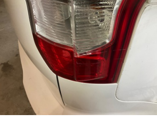
Arka lambalar, Arka lamba camı, sağ > Çatlak
