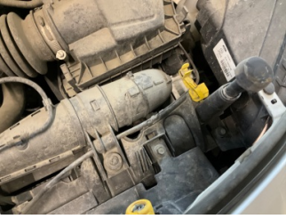
Motor, Hava filtresi kabı > Standart Dışı Onarım
