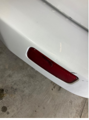
Tampon, arka, Reflektör, sağ > Kırılmış
