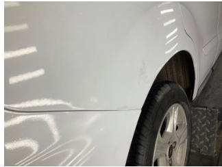
Çamurluk, sağ arka, Çamurluk, sağ arka > Ezik
