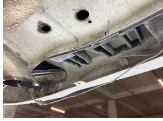
Tampon, arka, Bağlantı ayağı > Hasarlı
