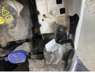
Farlar, Far bağlantı ayağı, sol > Hasarlı
