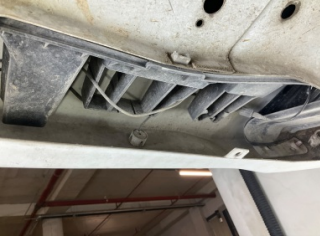
Tampon, arka, Bağlantı ayağı > Hasarlı
