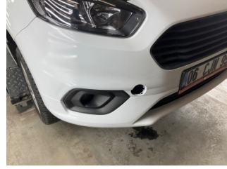
Tampon, ön, Çeki demir kapağı > Sökülmüş-Yok
