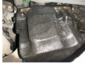
Motor, Motor > Yağ Kaçağı
