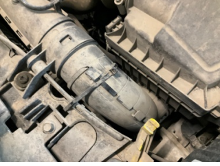
Motor, Hava filtresi kabı > Standart Dışı Onarım
