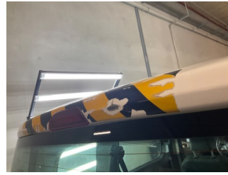
Bagaj kapağı/kapısı, Bagaj kapısı > Boyası Atmış
