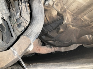
Şanzıman, Şanzıman > Yağ Kaçağı
