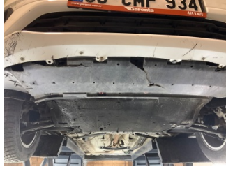
Tampon, ön, Tampon koruyucu orta > Hasarlı
