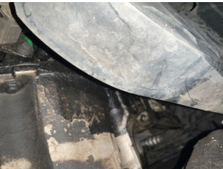
Motor, Motor > Yağ Kaçağı
