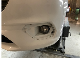
Sis lambaları, Sis Izgarası Sol > Sökülmüş-Yok
