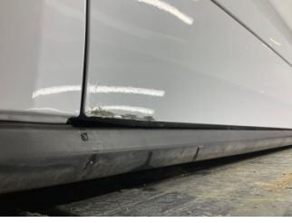
Kapı, sol  n, Kapı, sol  n > Ezik
