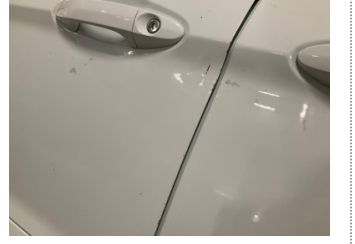
Kapı, sol  n, Kapı, sol  n > Ezik
