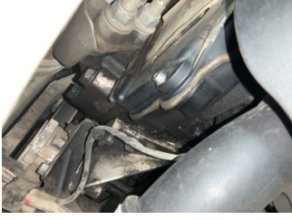
Motor, Külbütör kapağı > Yağ Kaçağı
