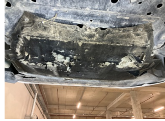
Motor, Alt muhafaza > Hasarlı
