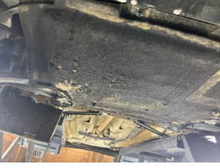
Motor, Alt muhafaza > Deforme Olmuş
