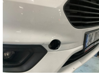
Tampon, ön, Çeki demir kapağı > Sökülmüş-Yok
