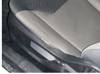
Koltuklar, ön, Koltuk, sol ön > Hasarlı
