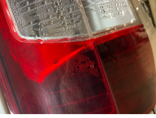
Arka lambalar, Arka lamba camı, sol > Çatlak
