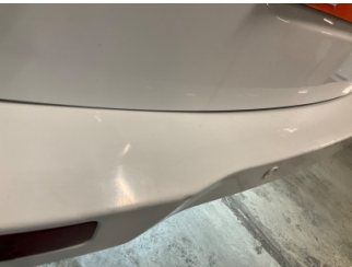
Tampon, arka, Arka tampon > Çatlak
