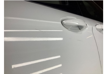
Kapı, sol arka, Kapı, sol arka > Çizik
