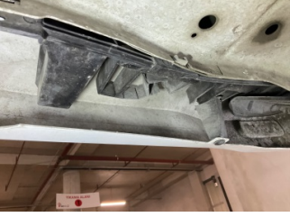
Tampon, arka, Bağlantı ayağı > Hasarlı
