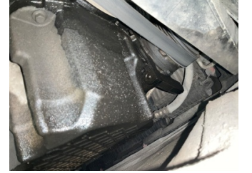
Motor, Motor > Yağ Kaçağı
