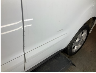
Kapı, sol arka, Kapı, sol arka > Çizik
