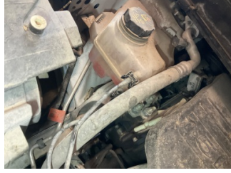
Motorsoğutması, Soğutma sıvısı > Eksik
