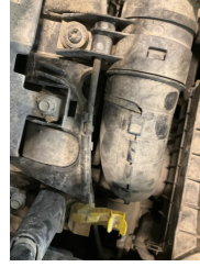
Motor, Hava filtresi kabı > Hasarlı
