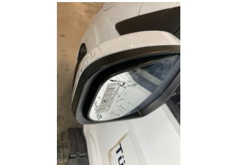
Dikiz aynası, sol, Ayna camı > Hasarlı
