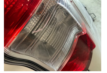
Arka lambalar, Arka lamba camı, sağ > Çatlak
