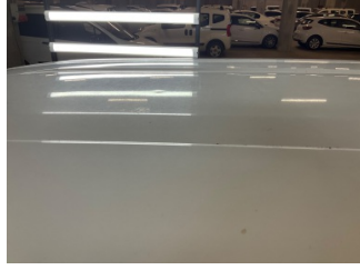
Tavan, Tavan > Dolu Hasarlı
