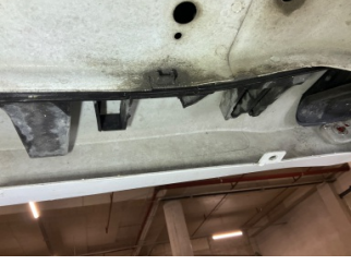
Tampon, arka, Bağlantı ayağı > Hasarlı
