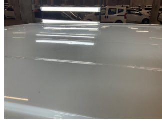
Tavan, Tavan > Dolu Hasarlı
