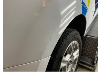
Çamurluk, sağ arka, Çamurluk, sağ arka > Ezik
