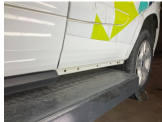
Marşbiyel, sol, Marşbiyel plastiği, sol > Sökülmüş-Yok
