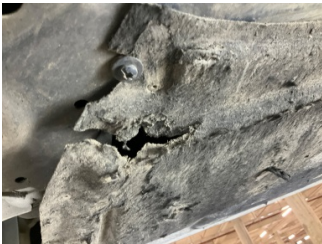
Motor, Alt muhafaza > Hasarlı
