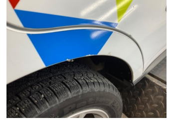
Çamurluk, sağ arka, Çamurluk, sağ arka > Ezik
