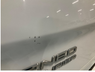
Bagaj kapağı/kapısı, Bagaj kapısı > Ezik
