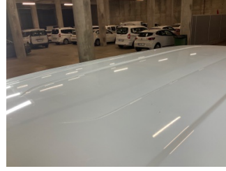
Tavan, Tavan > Dolu Hasarı
