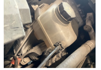
Motorsoğutması, Soğutma sıvısı > Eksik
