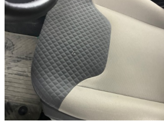
Döşemeler/Kapaklar, Döşemeler/Kapaklar > Yakıcı Madde ile Zarar Görmüş
