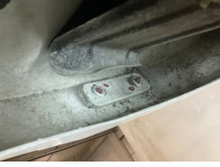
Tampon, arka, Bağlantı ayağı > Hasarlı
