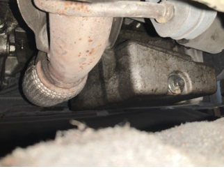
Motor, Motor > Yağ Kaçağı
