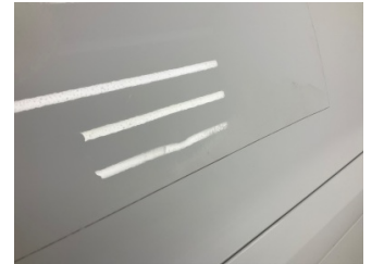
Kapı, sol ön, Kapı, sol ön > Ezik
