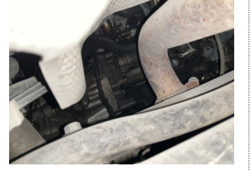
Motor, Motor > Yağ Kaçağı
