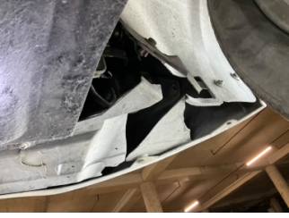
Tampon, ön, Tampon koruyucu orta > Hasarlı
