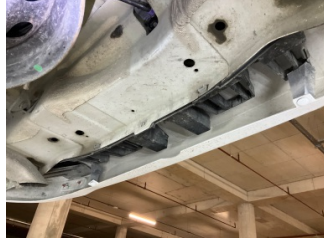
Tampon, arka, Bağlantı ayağı > Hasarlı
