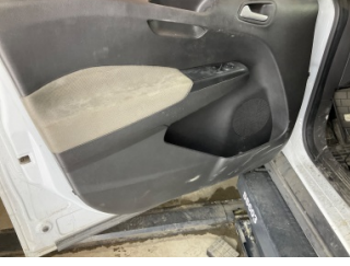
Döşemeler/Kapaklar, Döşemeler/Kapaklar > Deforme Olmuş
