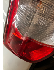
Arka lambalar, Arka lamba camı, sol > Çatlak
