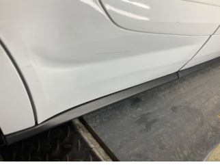
Kapı, sağ arka, Kapı, sağ arka > Ezik
