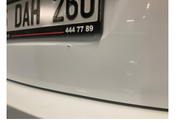
Bagaj kapağı/kapısı, Bagaj kapısı > Ezik
