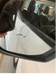
Dikiz aynası, sol, Ayna camı > Hasarlı
