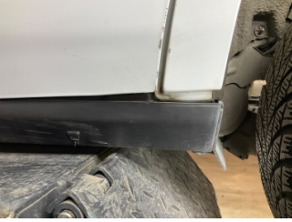
Marşbiyel, sol, Marşbiyel, sol > Sabitlemesi Hatalı
