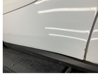
Kapı, sol arka, Kapı, sol arka > Çizik
