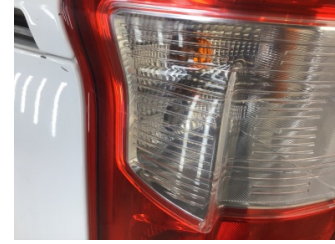
Arka lambalar, Arka lamba camı, sol > Çatlak
