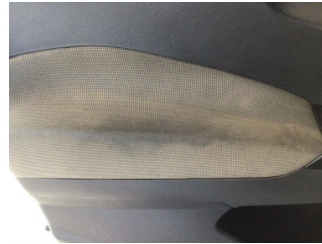
Döşemeler/Kapaklar, Kapı döşemesi, sol ön > Deforme Olmuş
