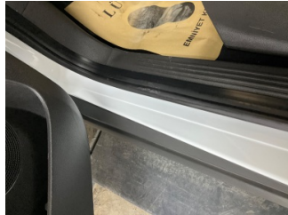
Döşemeler/Kapaklar, Döşemeler/Kapaklar > Çizik
