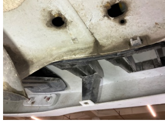
Tampon, arka, Bağlantı ayağı > Hasarlı
