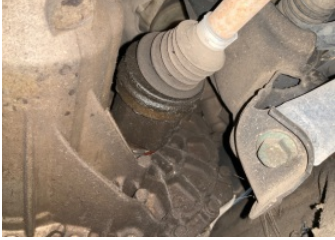
Ön aks, Aks mili, sol > Yağ Kaçağı
