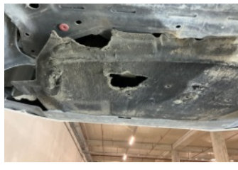
Motor, Alt muhafaza > Hasarlı
