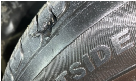
Lastik, sağ ön > Hasarlı
