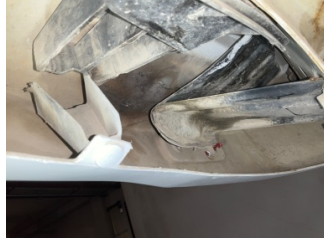
Tampon, arka, Bağlantı ayağı > Hasarlı
