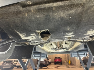
Motor, Alt muhafaza > Hasarlı
