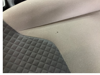
Döşemeler/Kapaklar, Döşemeler/Kapaklar > Yakıcı Madde ile Zarar Görmüş
