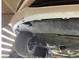
Tampon, ön, Tampon koruyucu orta > Hasarlı
