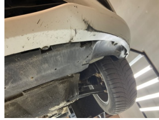
Tampon, ön, Tampon koruyucu orta > Hasarlı
