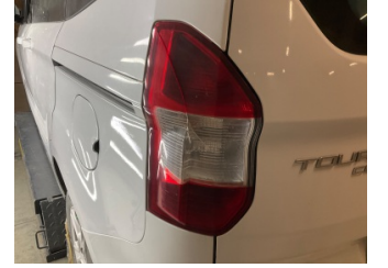
Arka lambalar, Arka lamba camı, sol > Hasarlı
