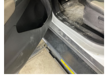
Döşemeler/Kapaklar, Döşemeler/Kapaklar > Çizik
