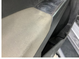
Döşemeler/Kapaklar, Döşemeler/Kapaklar > Yakıcı Madde ile Zarar Görmüş
