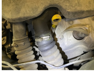
Motor, Turbo > Yağ Kaçağı
