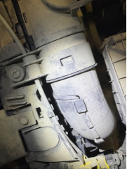
Motor, Hava filtresi kabı > Kırılmış
