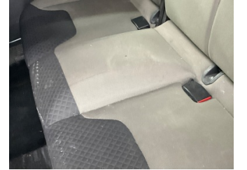
Döşemeler/Kapaklar, Döşemeler/Kapaklar > Yakıcı Madde Ile Zarar Görmüş
