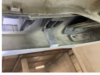
Tampon, arka, Bağlantı ayağı > Kırılmış
