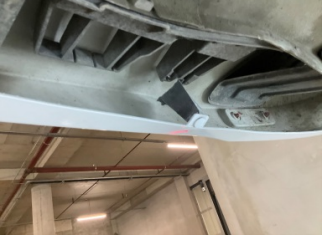
Tampon, arka, Bağlantı ayağı > Kırılmış
