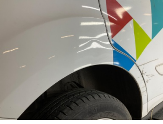
Çamurluk, sağ arka, Çamurluk, sağ arka > Ezik
