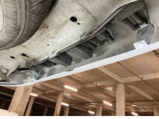
Tampon, arka, Bağlantı ayağı > Kırılmış
