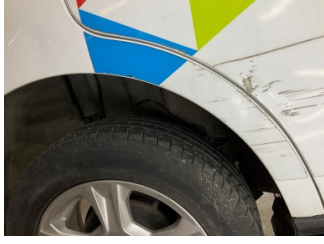
Çamurluk, sağ arka, Çamurluk, sağ arka > Ezik
