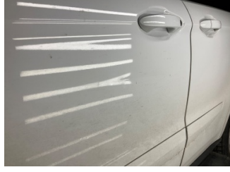
Kapı, sol ön, Kapı, sol ön > Ezik
