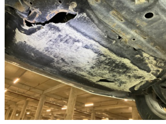
Motor, Alt muhafaza > Hasarlı
