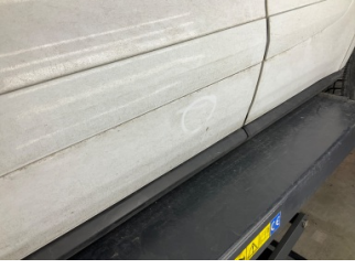
Kapı, sol ön, Kapı, sol ön > Ezik
