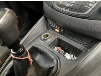
Elektrik donanımı/Pano, Çakmak > Sökülmüş-Yok
