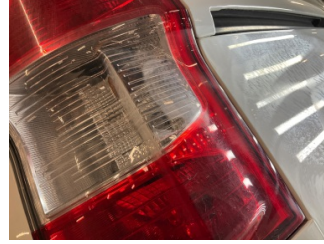
Arka lambalar, Arka lamba camı, sağ > Çatlak
