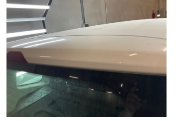
Bagaj kapağı/kapısı, Bagaj kapısı > Ezik
