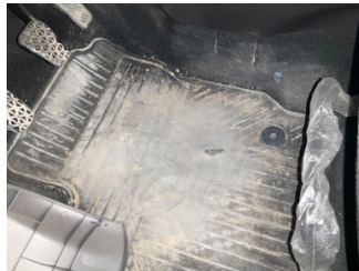
Taban, Paspaslar > Hasarlı
