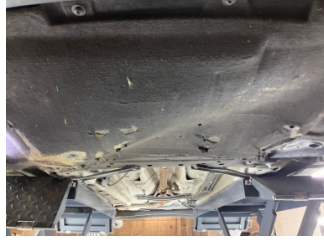
Motor, Alt muhafaza > Deforme Olmuş
