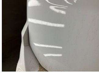
Bagaj kapağı/kapısı, Bagaj kapısı > Ezik
