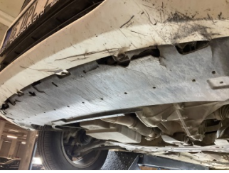
Tampon, ön, Tampon koruyucu orta > Hasarlı
