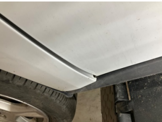
Çamurluk, sol, Çamurluk, sol > Sabitlemesi Hatalı
