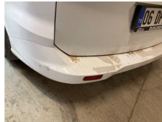
Tampon, arka, Arka tampon > Boyası Atmış
