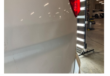
Bagaj kapağı/kapısı, Bagaj kapısı > Ezik
