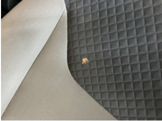
Döşemeler/Kapaklar, Döşemeler/Kapaklar > Yakıcı Madde Ile Zarar Görmüş
