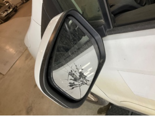
Dikiz aynası, sol, Ayna camı > Hasarlı
