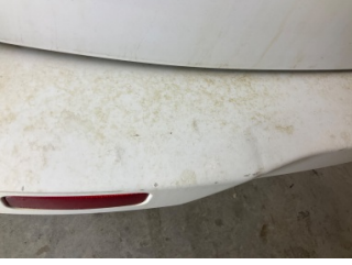
Tampon, arka, Arka tampon > Çatlak
