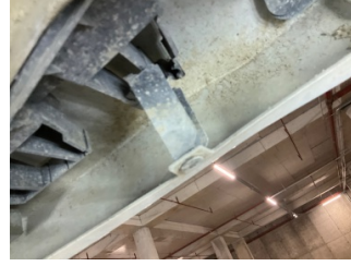
Tampon, arka, Bağlantı ayağı > Hasarlı
