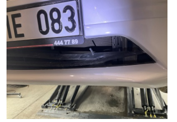
Tampon, ön, Ön tampon ızgarası > Hasarlı
