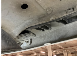
Tampon, arka, Bağlantı ayağı > Hasarlı
