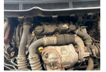
Motor, Motor üst kapağı, plastik > Sökülmüş-Yok
