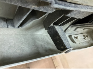
Tampon, arka, Bağlantı ayağı > Hasarlı
