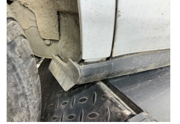
Marşbiyel, sağ, Marşbiyel plastiği, sağ > Sabitlemesi Hatalı
