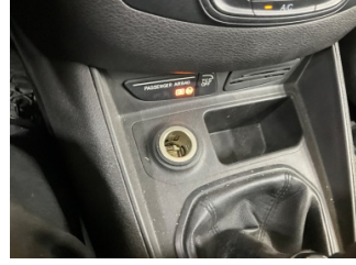
Elektrik donanımı/Pano, Çakmak > Sökülmüş-Yok
