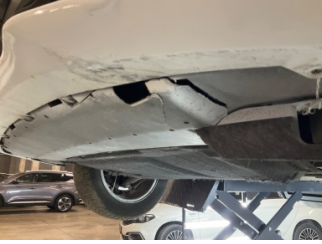
Tampon, ön, Tampon koruyucu orta > Hasarlı
