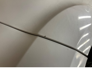
Çamurluk, sol, Çamurluk, sol > Boyası Atmış
