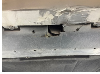
Tampon, ön, Tampon koruyucu orta > Hasarlı
