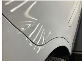
Kapı, sağ arka, Kapı, sağ arka > Ezik
