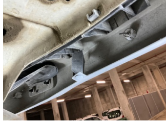
Tampon, arka, Bağlantı ayağı > Hasarlı
