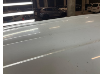
Tavan, Tavan > Dolu Hasarı
