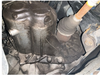
Şanzıman, Şanzıman > Yağ Kaçağı
