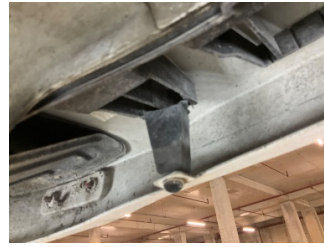
Tampon, arka, Bağlantı ayağı > Hasarlı
