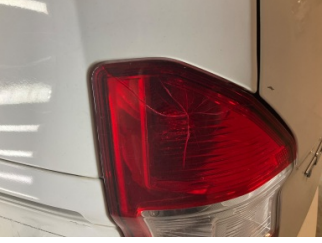
Arka lambalar, Arka lamba camı, sol > Hasarlı
