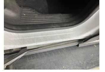
Marşbiyel, sağ, Marşbiyel, sağ > Boyası Atmış
