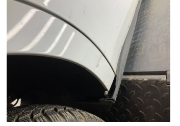
Çamurluk, sağ arka, Çamurluk, sağ arka > Ezik
