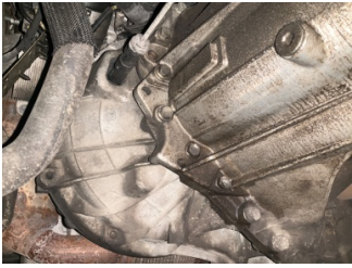
Şanzıman, Şanzıman > Yağ Kaçağı
